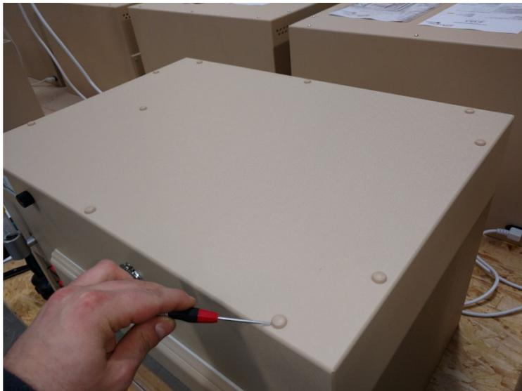
**Schritt 2:** Schrauben herausdrehen und Deckel abnehmen (falls nötig etwas mehr Kraft aufwenden, der Deckel ist teilweise verklebt).
