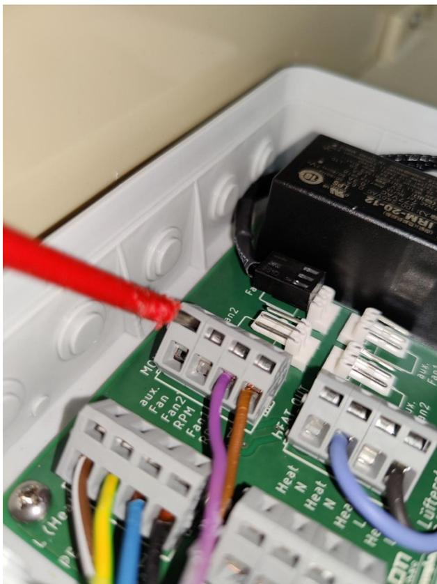
Die Klemmen werden mit Hilfe eines Schlitzschraubendrehers „aufgehelt“.
