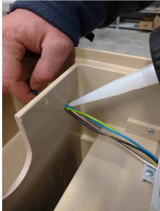
**Schritt 6:** Deckel des Verklemmkastens montieren. Kante vom Tank zum Brutraum mit Silikon versehen (im nachfolgenden Bild rot markiert).
