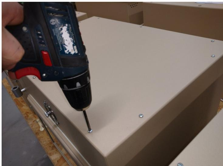
**Schritt 3:** Alte Lüfterhaube ausbauen, dazu die 4 Schrauben lösen und alle Kabel in dem Verklemmkasten mit einem geeigneten Schraubendreher lösen. Danach die Haube nach oben heraus nehmen.
